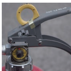
× 表示装置の脱落
