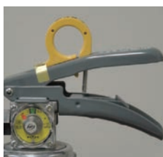
× レバー支えの脱落
