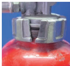
× キャップの破損
