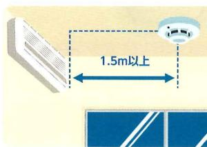
エアコンの吹き出し口から1.5m以上離して取り付けます。
